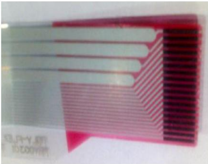
Zero Insertion Force ZIF
